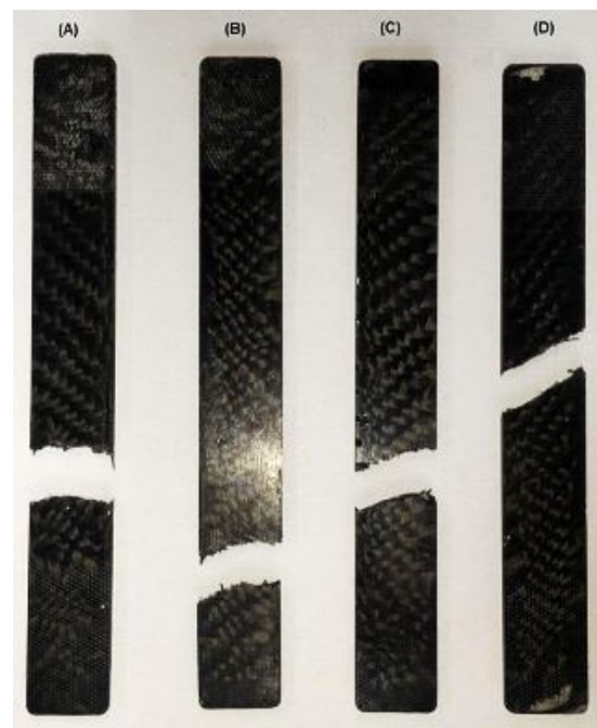
Figura 7 - Rupturas nos corpos de prova (A) 5 camadas; (B) 4 camadas; (C) 3 camadas e (D) 2 camadas.
