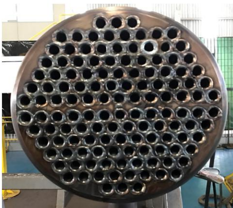
Fig. 5. Tubos soldados pelo processo TIG no espelho do trocador.
