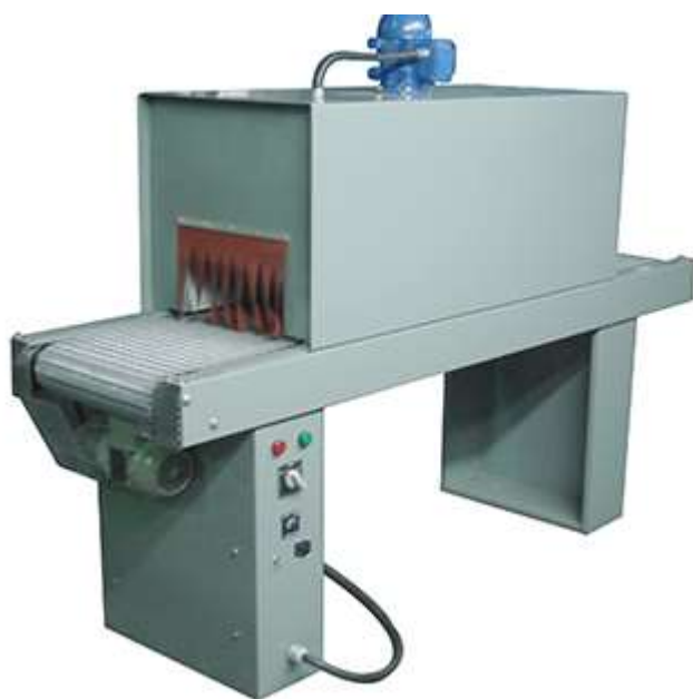
Fig. 1: Termoencolhedora para pacotes tipo shrink (MKM/2014)
