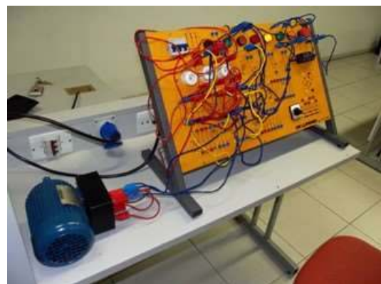
Figura 4. Painel de comandos elétricos didático com ligações para partida de motor elétrico.
