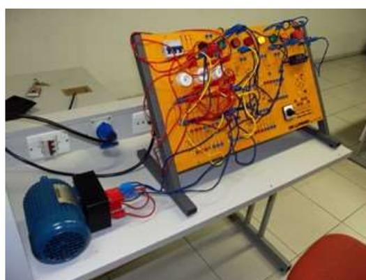
**Figura 4. Painel de comandos elétricos didático com ligações para partida de motor elétrico.**
