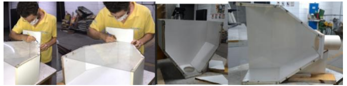
Figura 18 – Fotos da construção do silo de serragem
