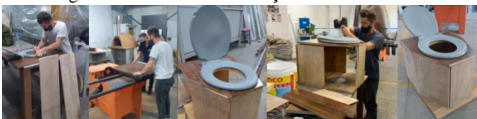
Figura 17 – Fotos da construção do sanitário seco
