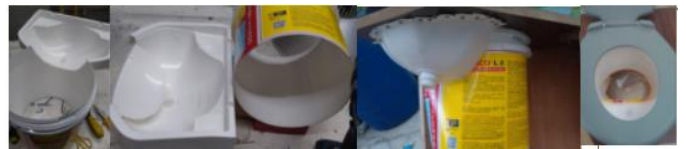
Figura 20 – Fotos do separador do sólido e do líquido reutilizando materiais usados
