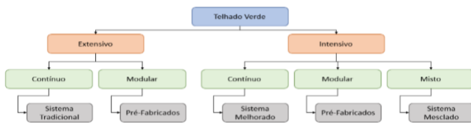
Figura 1 – Fluxograma da tipologia do Telhado Verde
