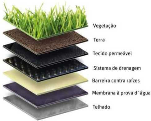
Figura 2 - Camadas do Telhado Verde
