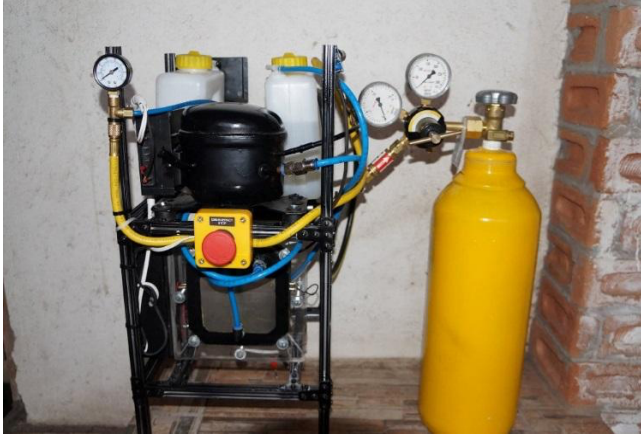
Figura 1 – Protótipo para a geração do hidrogênio.
