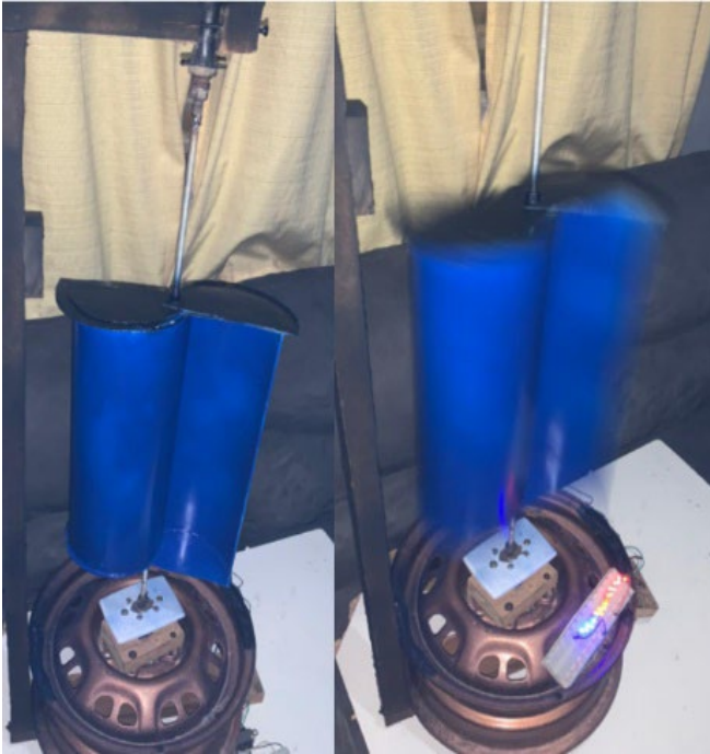
Figura 7 - Protótipo Aerogerador Darrieus Savonius.
