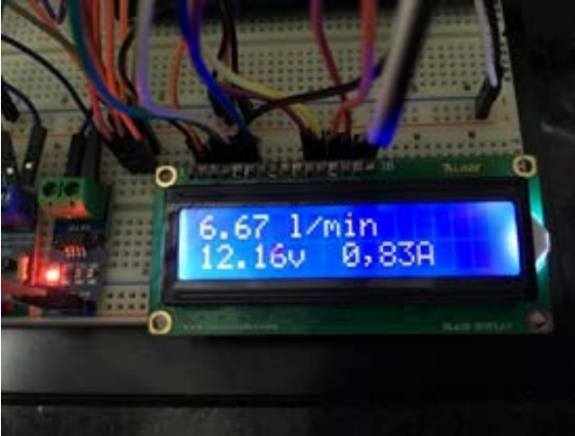
Figura 6 – Resultados da tensão e corrente em função da vazão.
