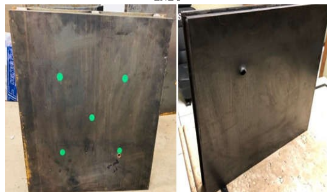
Figura 2 – Aspecto da amostra com 3,00 mm, especificação USIPROT 350 LNE 9
