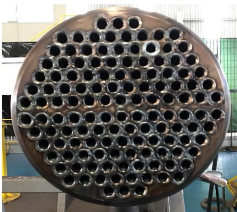
Fig. 5. Tubos soldados pelo processo TIG no espelho do trocador. [Fonte: Autor]
