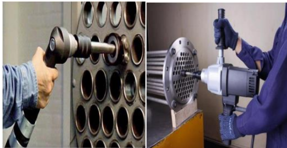
Fig. 2. Detalhe do processo de expansão dos tubos trefilados. [Fonte: Autor]
