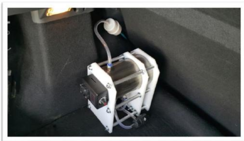
Figura 7 – célula de hidrogênio instalado no veículo
