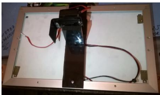
Figura 10 – Suporte e LDR's na placa
